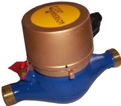
Medición efectiva de fluidos de baja densidad en temperaturas menores a 45°C compuesto por turbinas tipo S, cuerpo pintado en Epoxi y roscas laminadas para maximizar la durabilidad.
