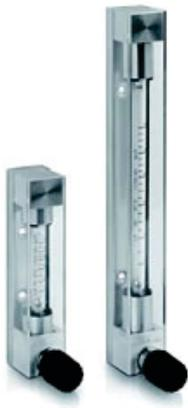
La línea está compuesta por medidores del tipo rotámetro, instrumentos que miden fluidos a través de la velocidad de flujo, según su viscosidad y densidad, basados en el concepto del área variable. Estos instrumentos presentan una sección cónica que le brinda una correcta apreciación del fluido a medir aplicable tanto a líquidos como en gases (según su versión)
