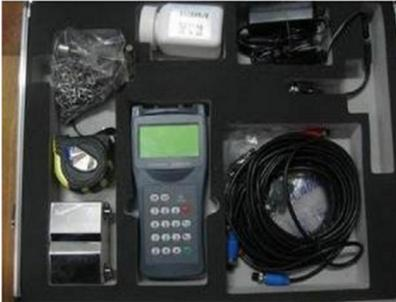
El sistema de medición está diseñado para que un operador pueda tomar mediciones de una o más tuberías con un sistema portátil, ligero y de fácil montaje. La línea brinda una respuesta de gran precisión a la hora de realizar múltiples mediciones de campo.
