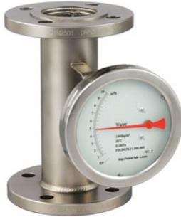
La línea Krl-600 está compuesta por medidores del tipo rotámetro los cuales se definen como instrumentos que miden los gases y/o líquidos a través de la velocidad de flujo, según su viscosidad y densidad, basados en el concepto del Cono recto, estos instrumentos presentan una sección cónica que le brinda una correcta apreciación del fluido a medir aplicable tanto a líquidos como gases (según su versión)
