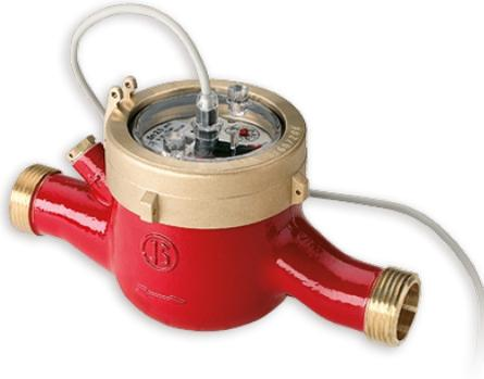
Este dispositivo trabaja mecánicamente de una forma similar a un medidor de chorro único, excepto que la curvatura de la circunferencia de la unidad está dada para que el fluido la recorra homogéneamente dirigiendo el flujo en el impulsor al igual desde varios puntos alrededor de la circunferencia del elemento, no sólo un punto, lo que minimiza el desgaste desigual en el impulsor y su eje, además de brindarle una significativa mejora en la precisión.
