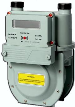
Los caudalímetros a diafragma de Gery Anderson son dispositivos utilizados para la mensura de volumen en fluidos de estado gaseoso mediante diafragmas de membrana flexible, las cuales conforman parcialmente las cámaras de medición, siendo desplazadas alternativamente en función al fluido circulante. Estos medidores se destacan por su fácil instalación, prácticamente nulo mantenimiento así como por su capacidad de mensurar gases a muy bajas presiones.
