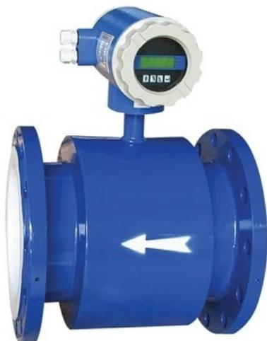
Los caudalímetros de acción magnética ofrecen mediciones de alta precisión, gran versatilidad de aplicación y fluidos a mensurar. Basados en la ley de Faraday que enuncia que el voltaje inducido a través de un conductor que se desplaza transversal a un campo magnético es proporcional a la velocidad del conductor, este sistema es muy poco intrusivo, funcionando sólo con líquidos que tengan algo de conductividad eléctrica.
