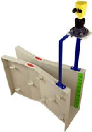
La Linea KBA de Turbinas tipo Parshall de gran robustez fabricados en P.R.F.V. (Poliéster Reforzado con Fibra de Vidrio) con resinas de gran resistencia química. Están dotados de nervios en AISI 316, que les confiere gran rigidez para respetar la fiabilidad de sus mensuras.
