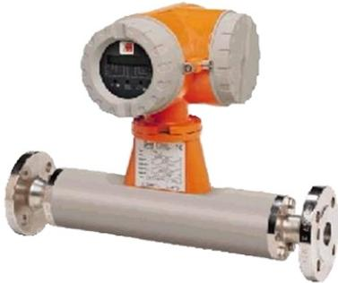
Los medidores de la línea KOC se basan en el efecto de Coreolis para realizar sus mediciones, el cual permite aprovechar la oscilación y velocidad del fluido a medir para así, por las fuerzas producidas dentro del medidor poder determinar con exactitud el caudal pasante.
