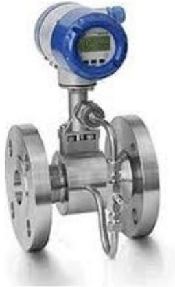
Estos medidores de flujo tipo cono en V presentan un sistema de alta precisión, aplicable a gran variedad de fluidos, todo tipo de condiciones. Utiliza el mismo principio físico que otros medidores de flujo de presión diferencial: el teorema de conservación de la energía del flujo de fluidos a través de una tubería. Las características de excelente desempeño del V-Cone, tanto en precisión como en bajo mantenimiento, son el resultado de su exclusivo diseño.
