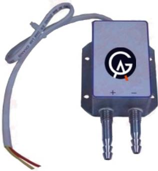
La línea KB de Gery Anderson, Abarca a los medidores cuyo principio de funcionamiento se basa en el principio de medición por presión diferencial, estos medidores emiten una precisa lectura del caudal a partir de una diferencia de presión producida por el fluido en una restricción en el paso del fluido.
